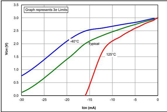
**FIGURE 36-37:**  $V_{OH}$  vs.  $I_{OH}$
