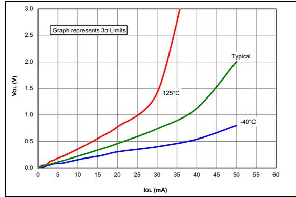
**FIGURE 36-38:**  $V_{OL}$  vs.  $I_{OL}$
