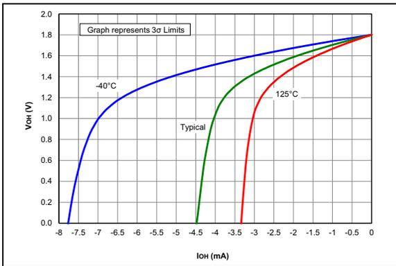
**FIGURE 36-39:**  $V_{OH}$  vs.  $I_{OH}$
