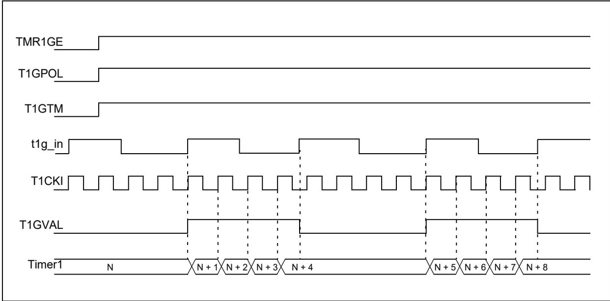
**FIGURE 27-6: TIMER1 GATE SINGLE-PULSE MODE**
